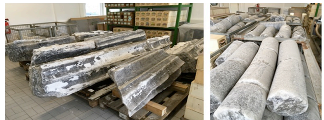
Abb. 1: Großbohrkerne und Salzquader zur Herstellung von Salzschnittblöcken
