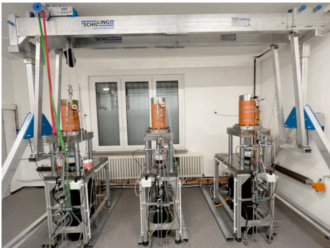
Abb. 4: Neuartige Versuchstechnik zur Bestimmung der Kriechrate bei kleinen deviatorischen Beanspruchungen
