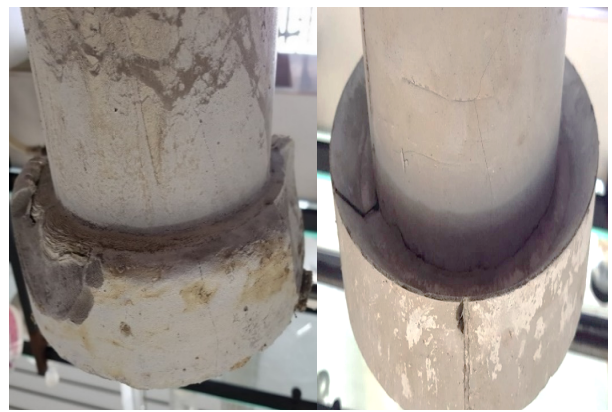
Abb. 3.: Experimenteller Nachweis der Zementationsverbesserung in einer Probenkammer zur Simulation des offenen Bohrloches. Einpumpen der Zementschlamm ohne (Links) und mit (Rechts) Vibrationsenergie (Pedrus et al., 2021)
