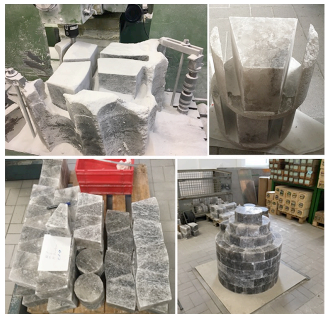
Abb. 2: Herstellung und Konfiguration von Salzschnittblöcken
